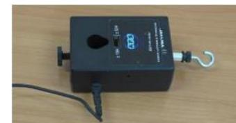
Рисунок 2. Датчик силы (динамометр)
