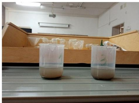
Приготовление вытяжки почвы для определения pH-среды
