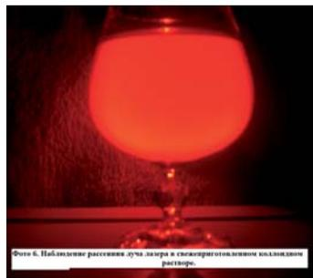
Фото 6. Наблюдение рассеяния луча лазера в свежеразбавленном коллоидном растворе.
