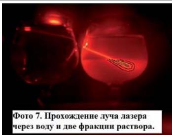
Фото 7. Прохождение луча лазера через воду и две фракции раствора.
