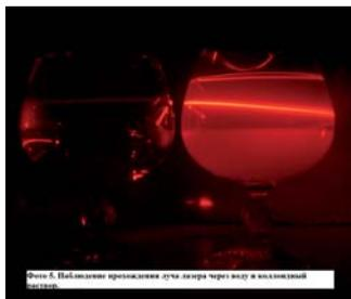
Фото 5. Наблюдение прохождения луча лазера через воду и коллоидный раствор.
