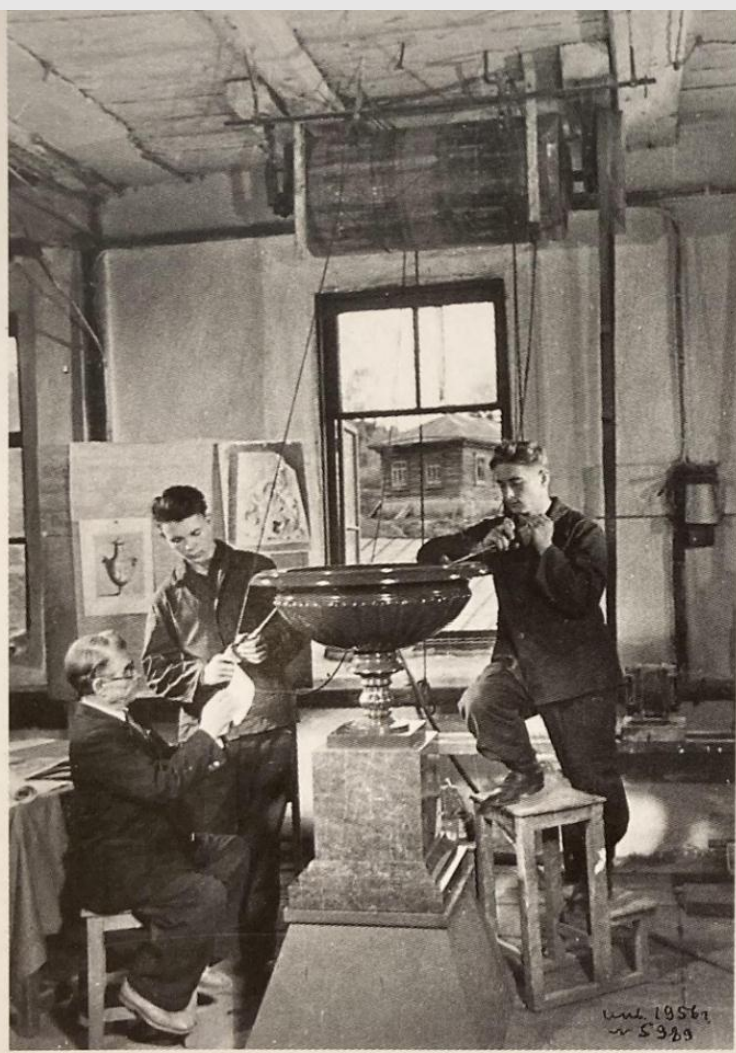
Обработка юбилейной чаши на Колыванском камнерезном заводе, 1952 г.
